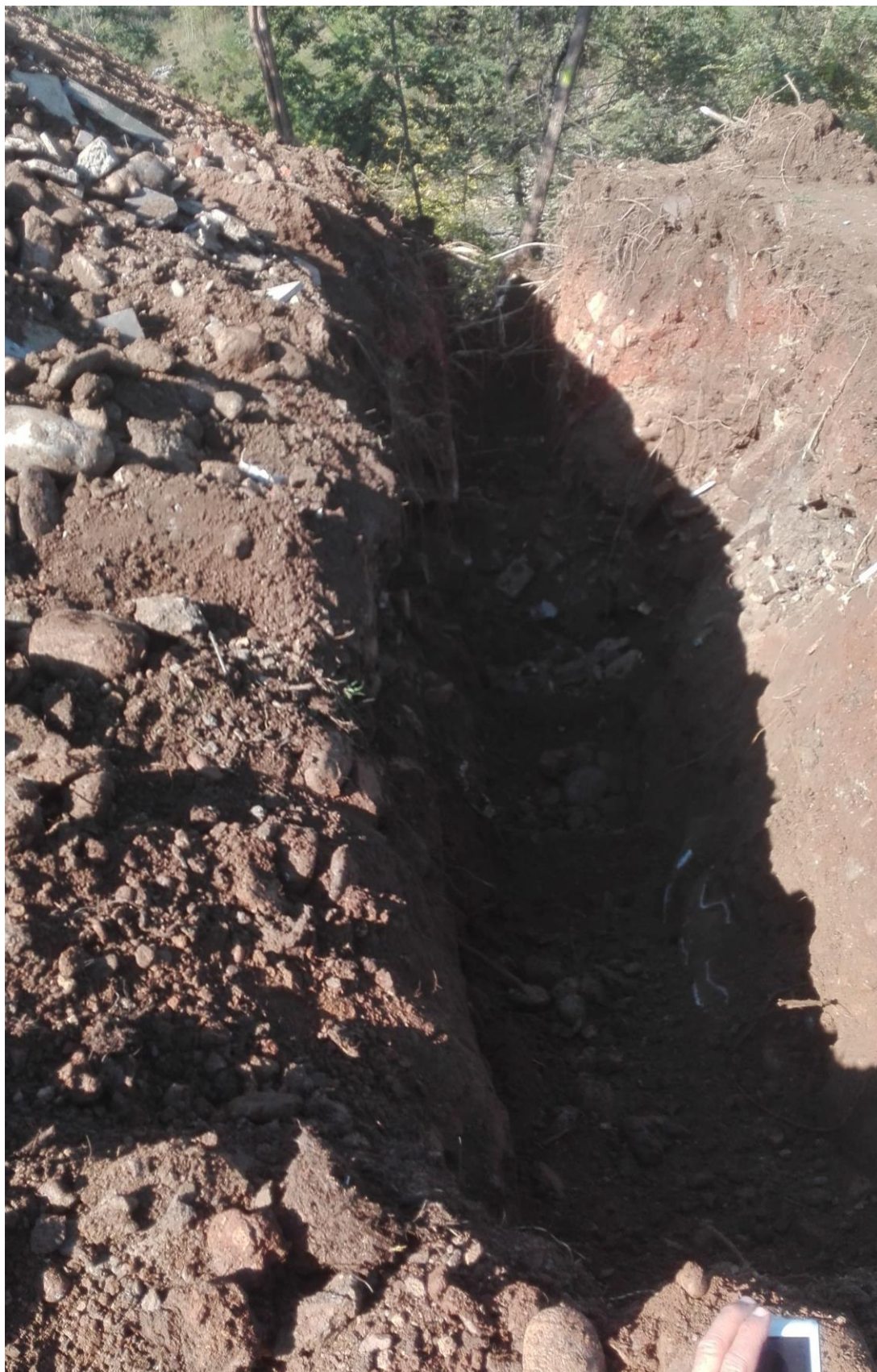
Foto 6: zona di ancoraggio sponda destra (lato Dronero) indagine geognostica - trincea esplorativa
