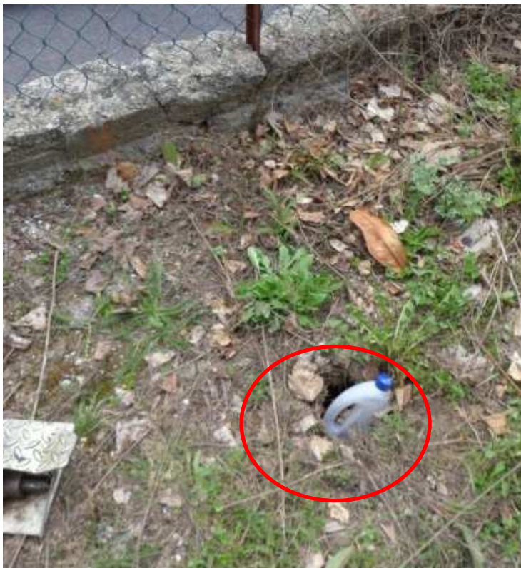
Prova penetrometrica 1 eseguita sotto tubo che drena le acque da monte . Prevedere di regimare le acque a valle
