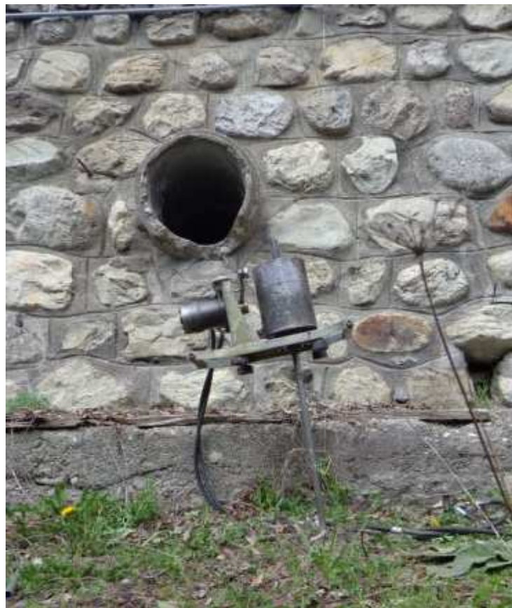
Prova penetrometrica 1 eseguita sotto tubo che drena le acque da monte . Prevedere di regimare le acque a valle
