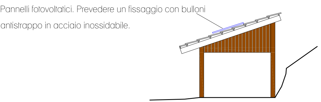
PROSPETTO EST RICOVERO ATTREZZI scala 1:100
